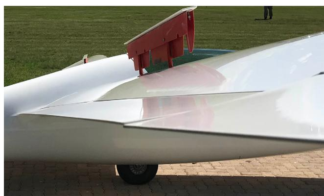
Slika 4. Kočnice i negativna zakrilca na Janusu
